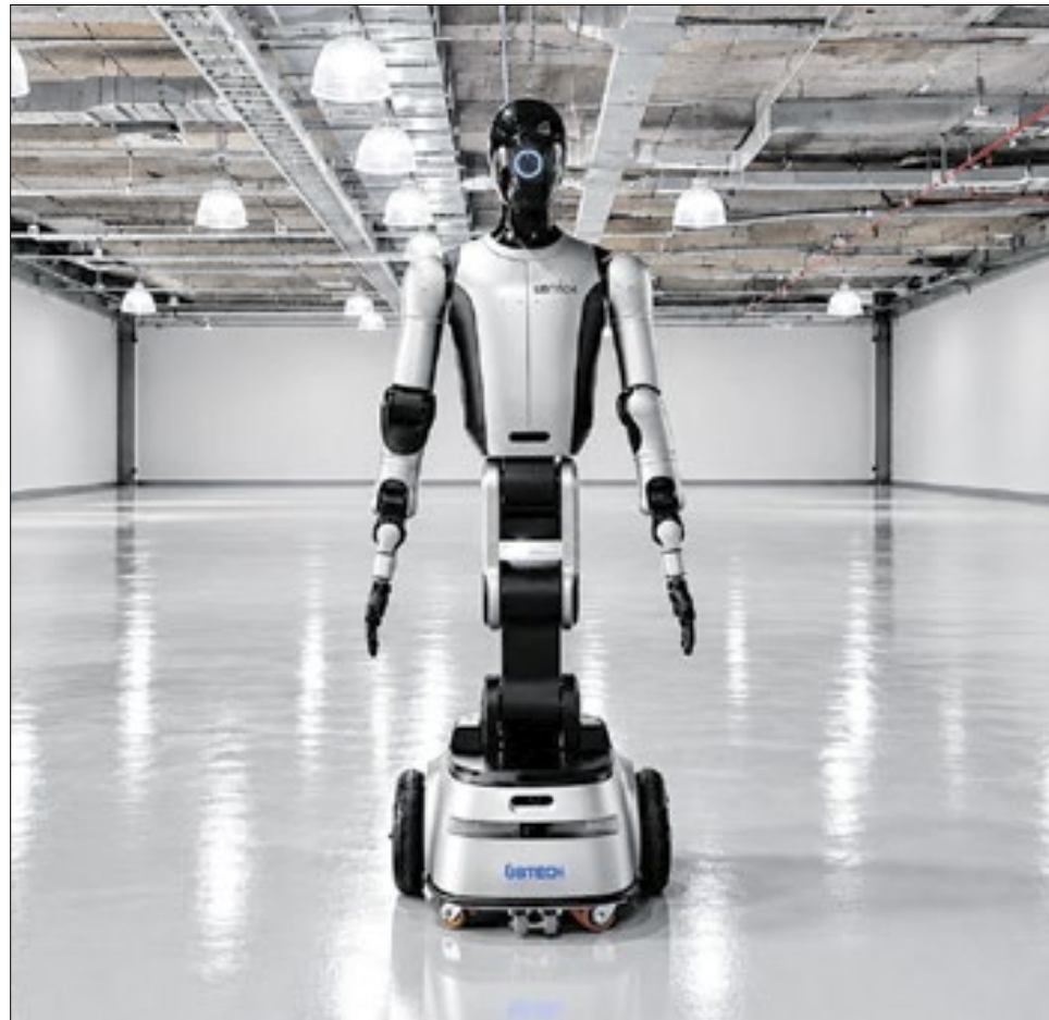
Cruzr S2 tem uma base móvel sobre rodas, braços articulados, câmeras e sensores que permitem identificar o ambiente
