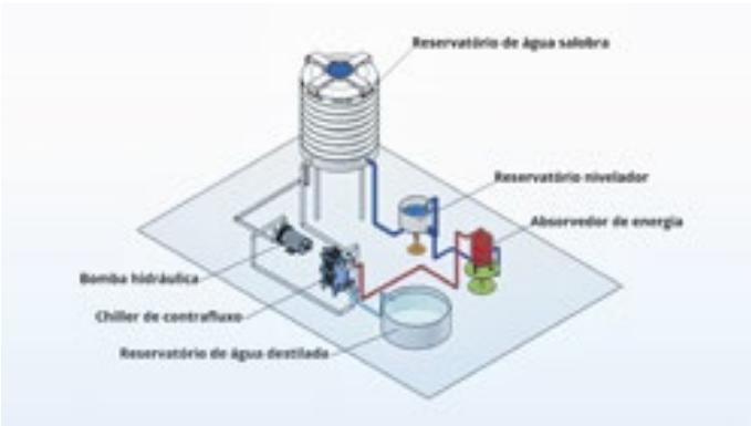
O sistema baseia-se na mudança de fase da água
