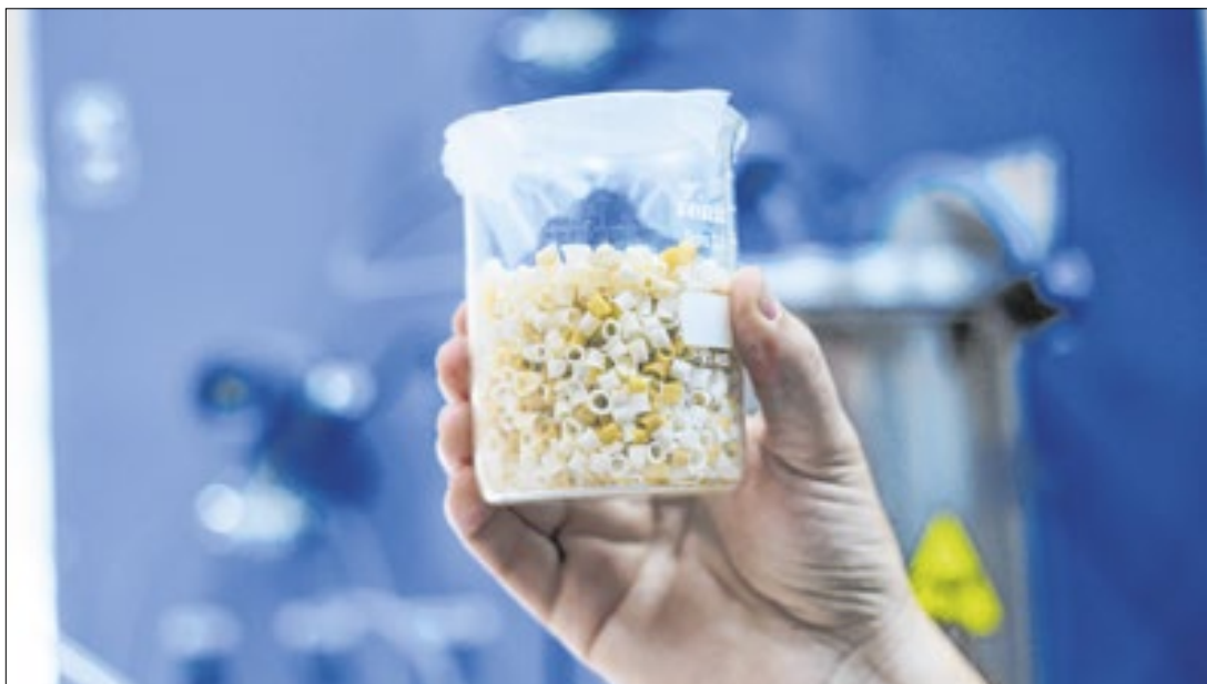
Tecnologia originou um processo de remoção de água no diesel que utiliza materiais superabsorventes
