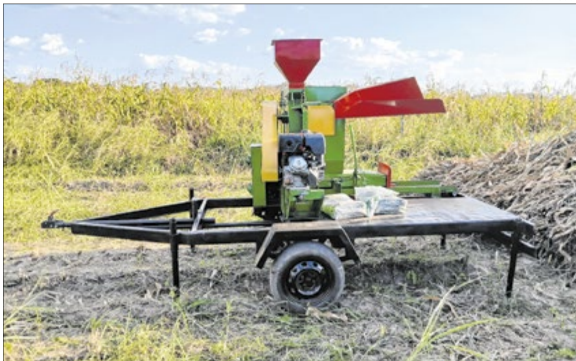
Máquina reúne as funções de forrageira, ensiladeira e ensacadora
