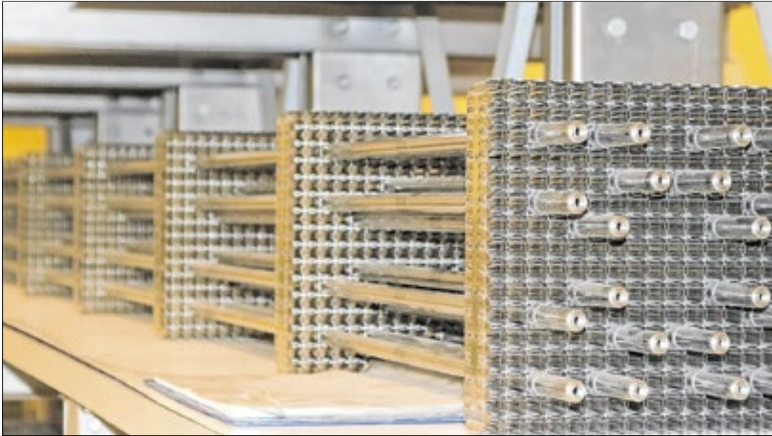
Elemento combustível em produção para usina Angra 2
