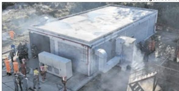
Estrutura em formato de garagem construída em São Paulo realiza simulações para embasar normas de segurança em estacionamentos
