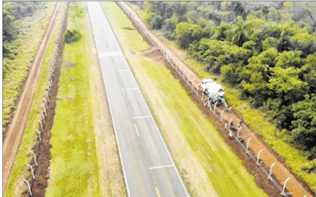
O novo sistema de cercas contínuas acompanha o traçado da pista, de ambos os lados
